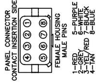
**Panel Wiring Diagram**
