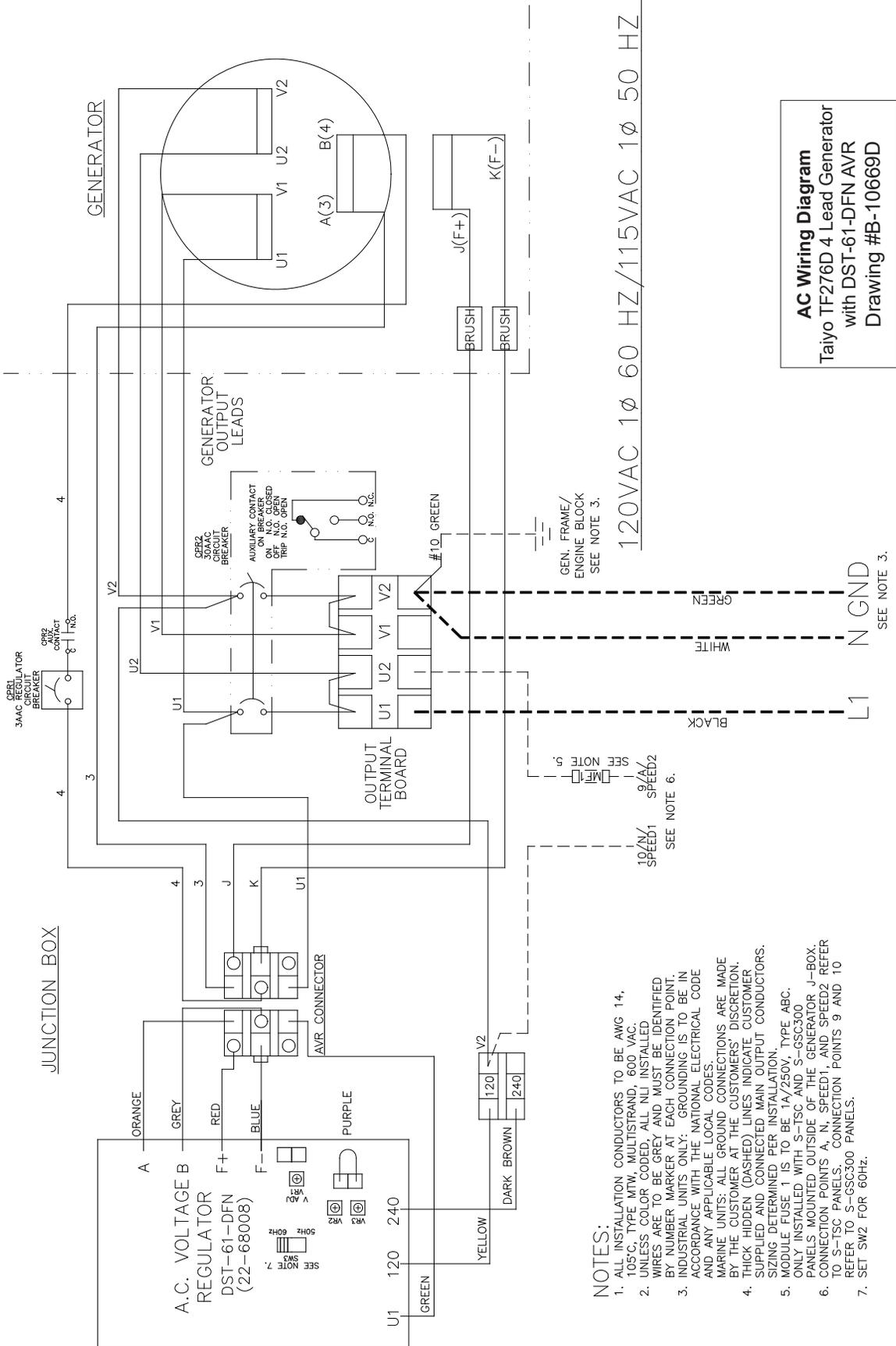
**AC Wiring Diagram**
